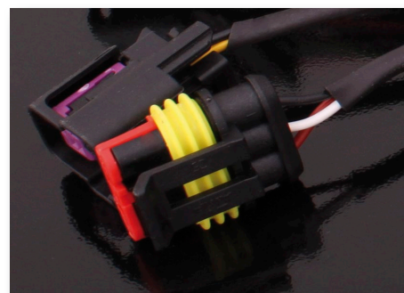
Fig 4.1a - 3-poliga Superseal kontakt. 1: GND. 2: AIN4 (0-5V). 3: +5V från ECU.
